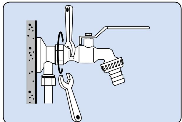
4 - Verrouiller la position en serrant le contre-écrou à l'aide d'une deuxième clé.
