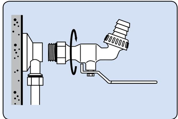
2 - Visser le robinet sur l'applique sans filasse ni téflon. La présence du joint torique assure l'étanchéité.
