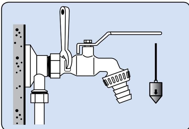
3 - Orienter le robinet dans la position souhaitée. Maintenir le robinet en place à l'aide d'une clé, et grâce aux méplats.
